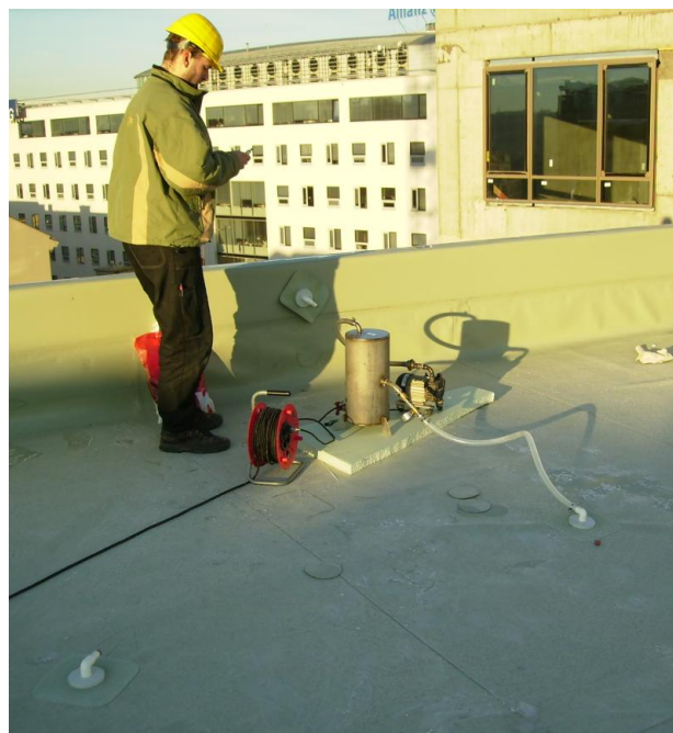
DVOJITÝ SEKTOROVANÝ KONTROLOVATELNÝ POVLAČ
