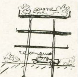
□ Le Corbusier, skica k druhému z „Pěti bodů nové architektury“: volné přizemí a zahrada na střeše. (Ve variantě skici z roku 1929 vylehčuje autor stavbu krakorcovými řešením konstrukce)
