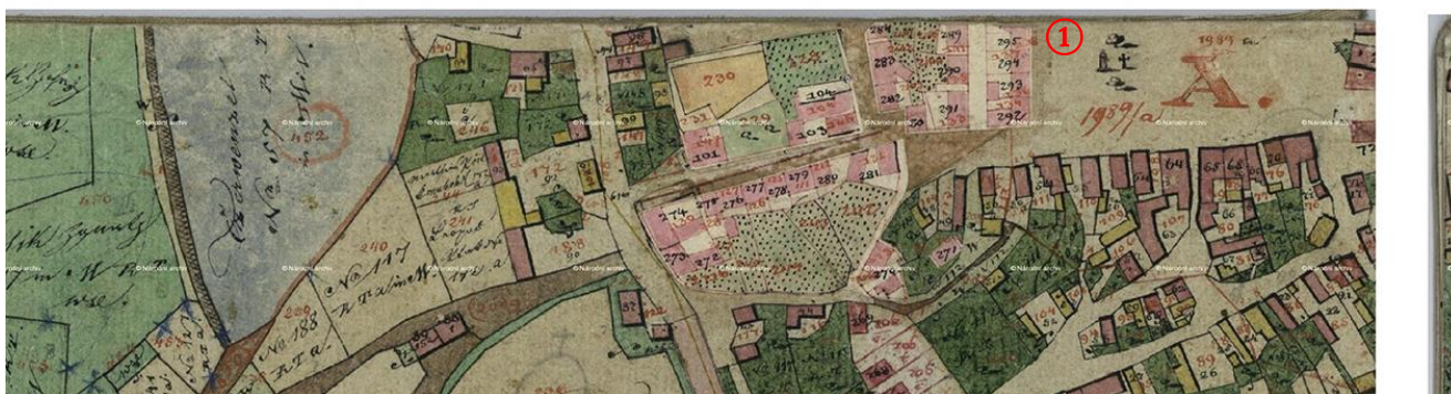
Obr. 59. Nově zakreslené pozemky a domy jsou na místě budov zničených požárem vyneseny do indikační skici na podlepený papír, překrývající starší stav. Pravidelné půdorysy, rozdělení zahrad, pravoúhlé uzavření náměstí. Upraven je i areál hřbitova.
