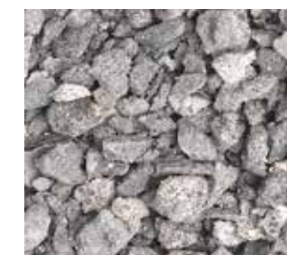
MECHANICKY ZPEVNĚNÉ KAMENIVO
