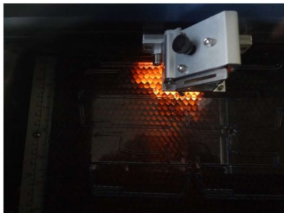
Model je vyroben v měřítku 1:100. Objekt je rozdělen do 188 řezů, tyto díly jsou vyřezány do Plexi skla pomocí laseru. Model je nařezán z 5 mm čirého PLEXI skla a následně slepen. Rozměry modelu jsou cca 84 x 10,4 x 6,2 cm. Pro model je vytvořen podstavec z čirého 5 mm PLEXI skla rozměrů 88 x 33 x 10 cm
