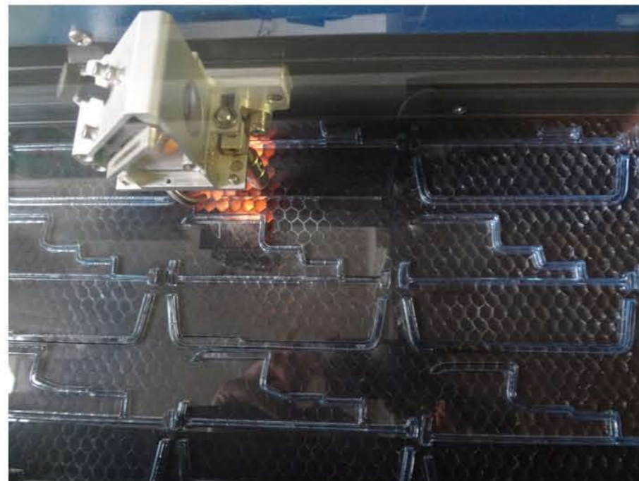
Model je vyroben v měřítku 1:100. Objekt je rozdělen do 188 řezů, tyto díly jsou vyřezány do Plexi skla pomocí laseru. Model je nařezán z 5 mm čirého PLEXI skla a následně slepen. Rozměry modelu jsou cca 84 x 10,4 x 6,2 cm. Pro model je vytvořen podstavec z čirého 5 mm PLEXI skla rozměrů 88 x 33 x 10 cm
