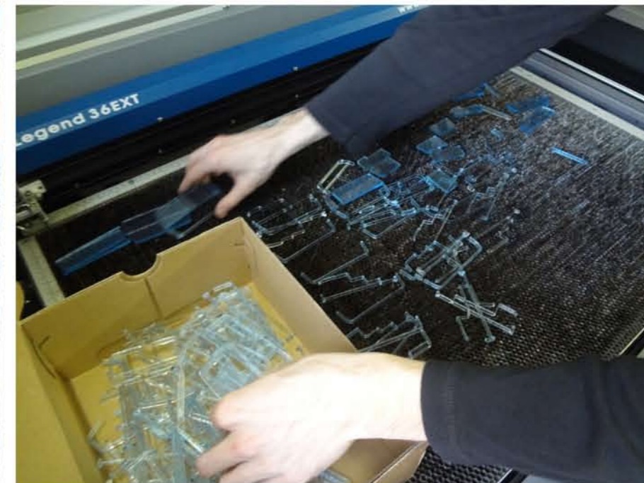
Model je vyroben v měřítku 1:100. Objekt je rozdělen do 188 řezů, tyto díly jsou vyřezány do Plexi skla pomocí laseru. Model je nařezán z 5 mm čirého PLEXI skla a následně slepen. Rozměry modelu jsou cca 84 x 10,4 x 6,2 cm. Pro model je vytvořen podstavec z čirého 5 mm PLEXI skla rozměrů 88 x 33 x 10 cm
