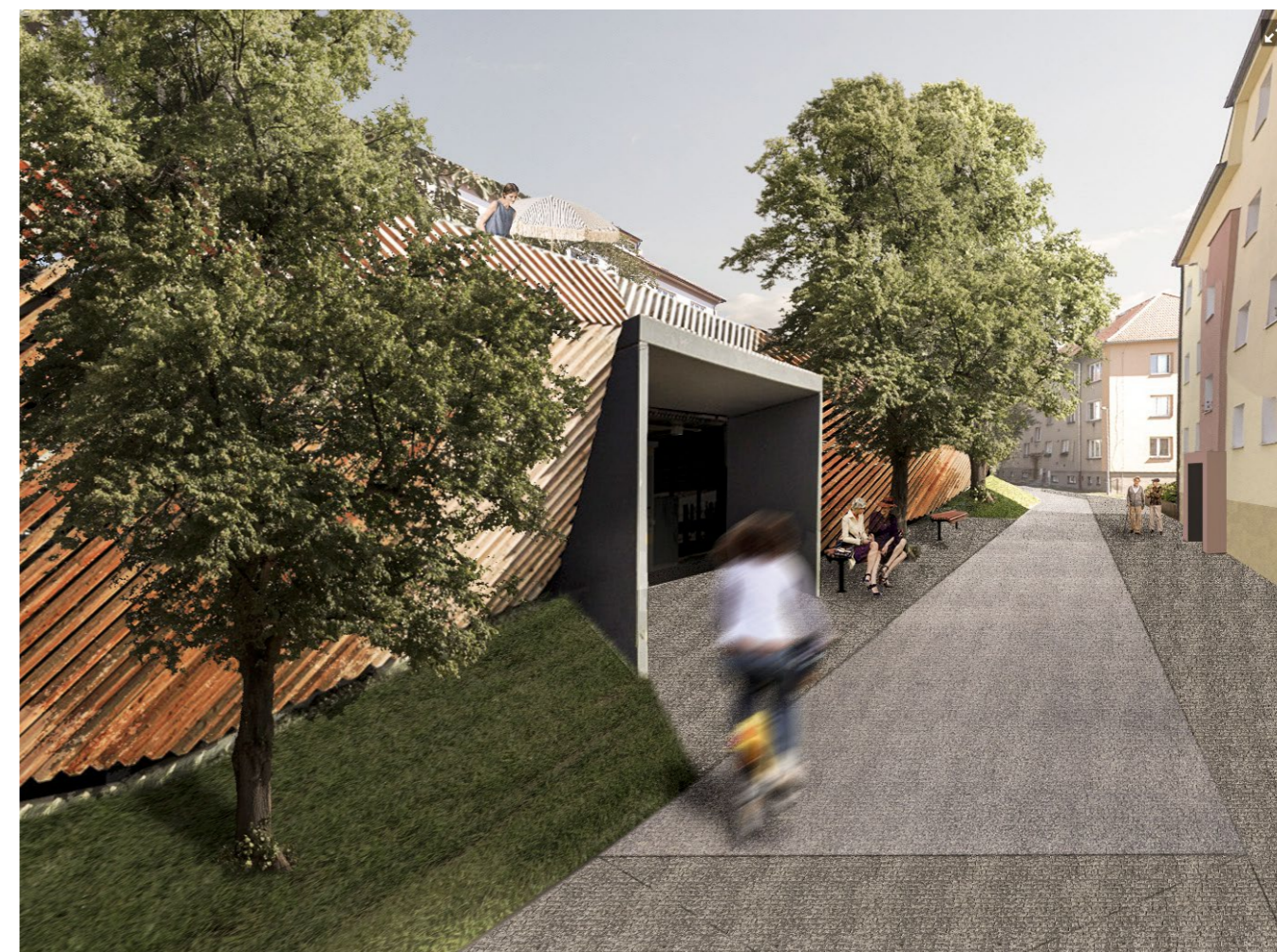
Pohled na novu podobu vnitroblokové komunikace. Vlevo polozapuštěná garáž, která je otevřená a prostor vnitrobloku obložená dřevem pro dosažení intimějšího charakteru vnitrobloku.
