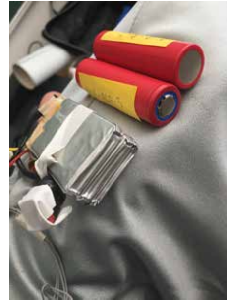
Pro porovnání plochá Lion baterie s výdrží jednoho článku 30 minut a druhé ba- terie s výdrží jednoho článku 1,5 hodiny
