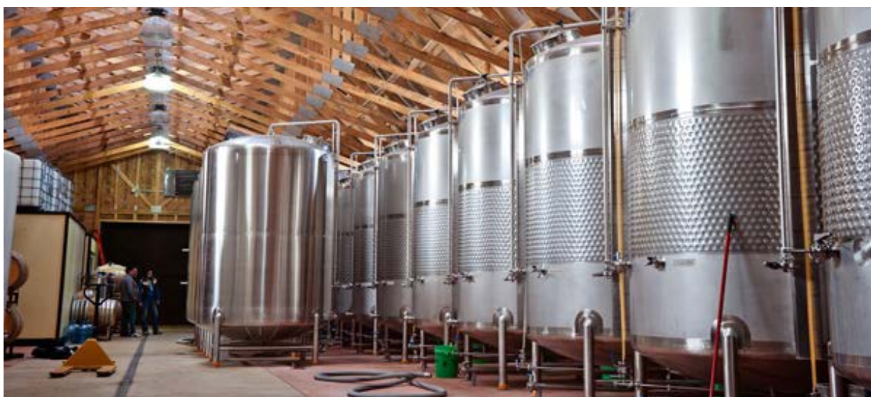
Příklad tanků pro kvašení cideru (Czech Brevery System s.r.o.)
