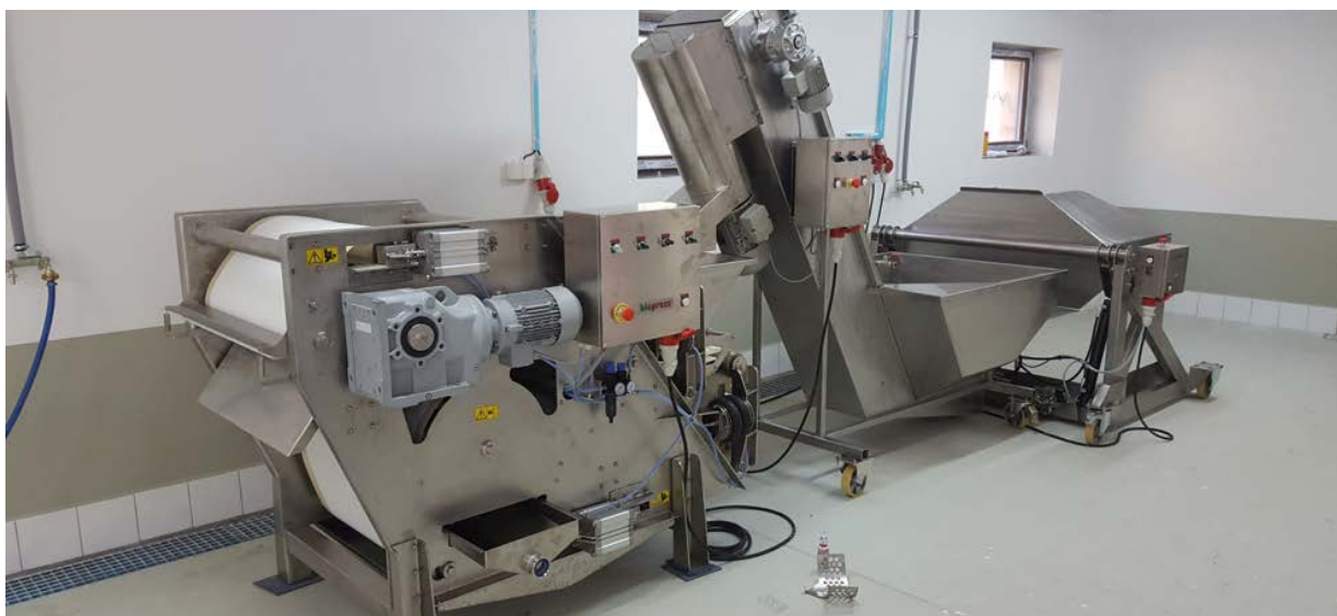
Příklad výrobní linky moštu v sestavě třídící stůl, drtič, průběžný lis (Biopress)
