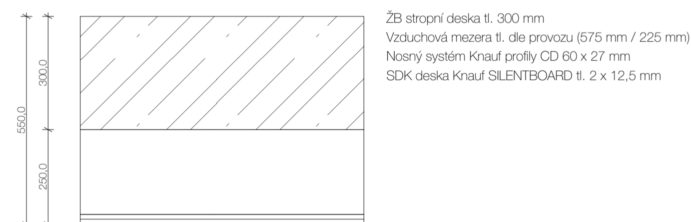
Po2 - Skladba akustického podhledu (nahrávací studio) M1:10
