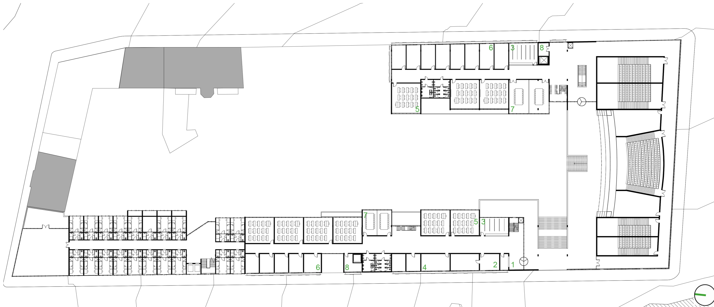
3NP, M 1:500 1_vstup | 2_děkanát | 3_šatna | 4_počítačová učebna | 5_učebna | 6_kabinet | 7_zasedací místnost | 8_nákladní výtah
