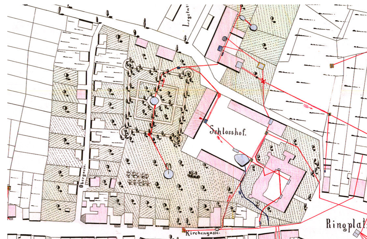
Obr. 13: Plán vodovodního řádu v Rokytnici z roku 1883
