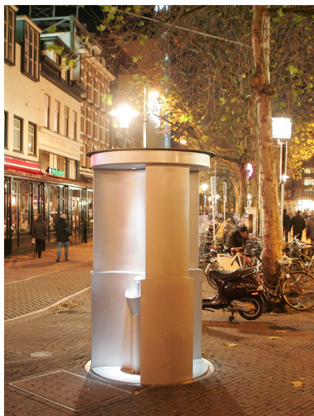
23 Urilift, Antverpy - na noc ze země vyjíždějící pisoár
