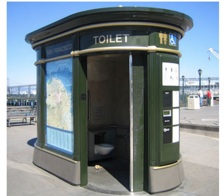
20 toaleta s posuvnými samo otevíracími dveřmi, JCDecaux
