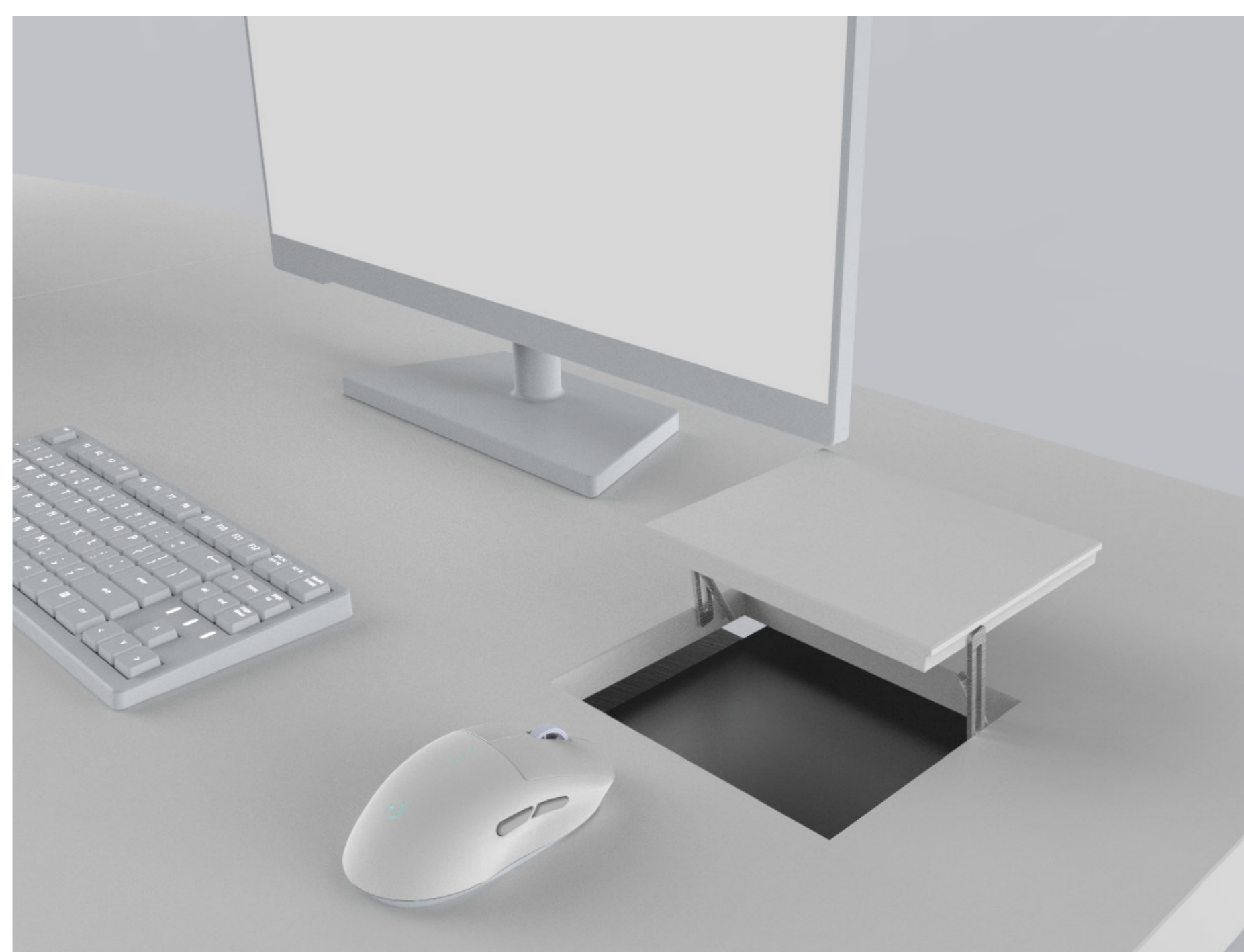
Návrh zabudovaného počítače do pracovního stolu
