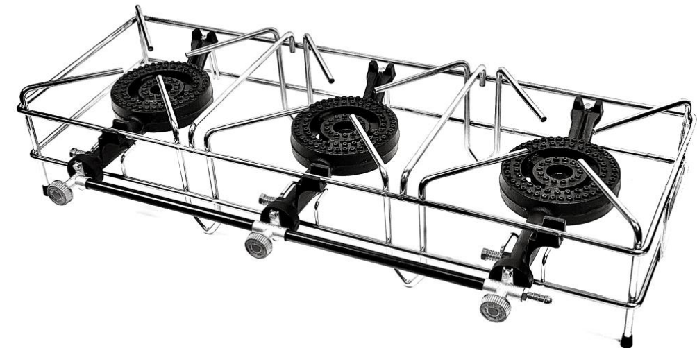
Obr. 13 – Foker Europa Industriale 03020F od výrobce Foker je plynový průmyslový vaříč na propan-butan. Skládá se ze tří hořáků. Celkový výkon dosahuje 12 kW. Hořáky jsou litinové a konstrukce ocelová. Váží 8 kg a nosnost má až 100 kg. Spotřeba plynu je 3 x 290 g/h. Je vhodný a spolehlivý na velké akce a velkokapacitní ohřev.
