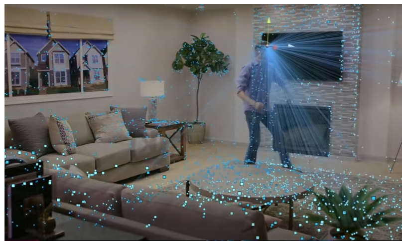
Obr. 11: princip snímání pomocí infra kamery, Oculus insight 2018
