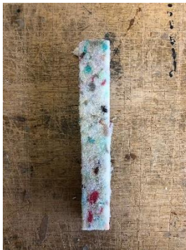
Obr. 28: Řez odporovým drátem
