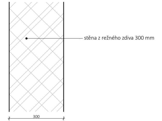
S4 SVISLÁ KONSTRUKCE PŘEDSAZENÁ STĚNA
