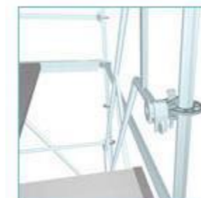
Příklad použití vnitřního zábradlí a schodišřového ramene, obojí vyrobeno z hliníku
