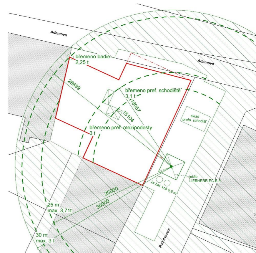
Schéma vzdáleností a tíh dopravovaných břemen
