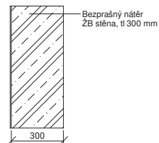
S12 STĚNA V SUTERÉNU S BEZPRAŠNÝM NÁTĚREM
