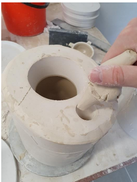
Obr. 119: archiv autora, vyškrubnutí přebytečné hmoty z nalévacího otvoru
