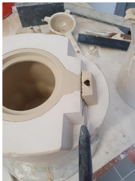
Obr. 119: archiv autora, vyškrubnutí přebytečné hmoty z nalévacího otvoru
