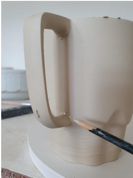
Obr. 124: archiv autora, vnitřní hrana lze zamýt ještě ve formě za použití točny a houby
