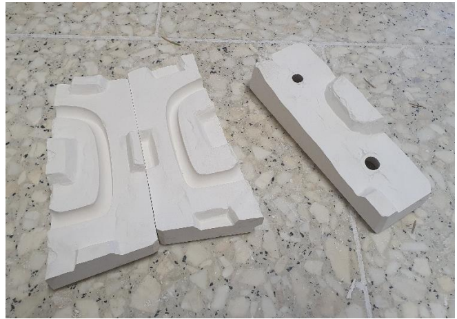
Obr. 110: archiv autora, dělicí rovina vymodelovaná z hlíny
