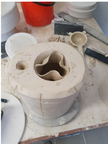
Obr. 117: archiv autora, vytrhnutí materiálu z nalévacího otvoru
