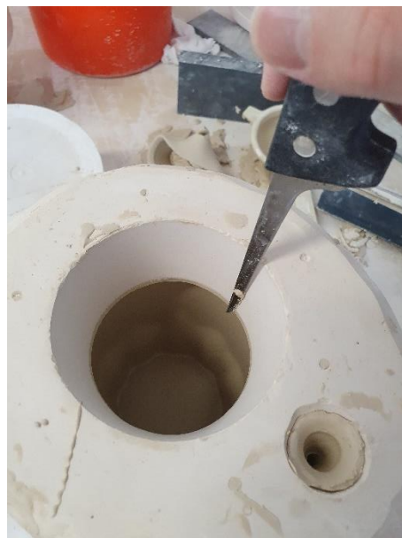
Obr. 117: archiv autora, vytrhnutí materiálu z nalévacího otvoru
