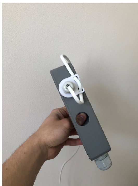
Obr. 72: Uchycení kabelu, archiv autora
