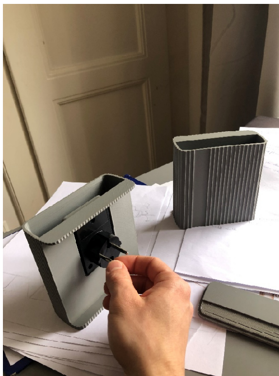
Obr. 54: ověření rozměrů pro zadní díl, archiv autora
