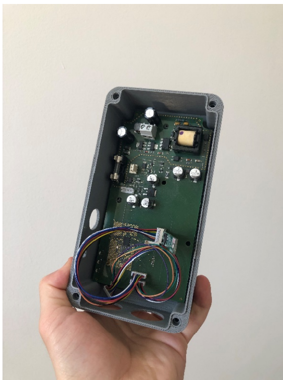
Obr. 67: Jednotka osazená vývodkami, archiv autora
