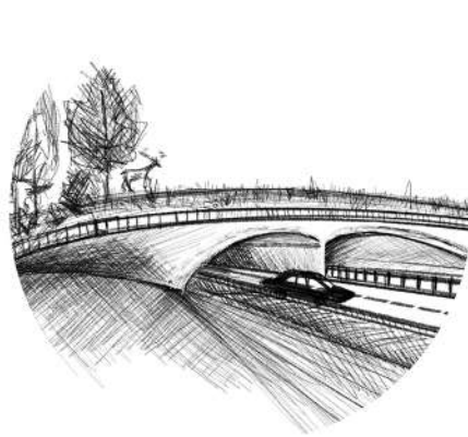
Obr.173: Ekodukt přes rychlostní silnici
