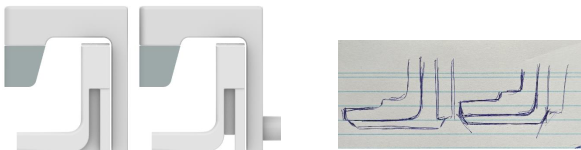
Obr. 95: Řešení problému s dutinou madla, prodloužení spodní části ramene, archiv autora, květen 2023
