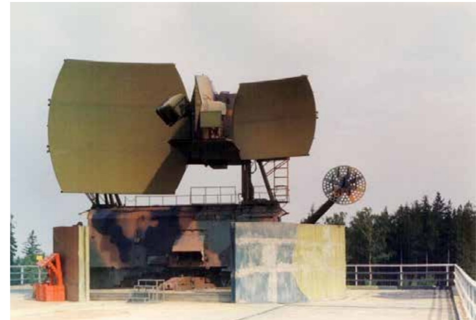
Anténa 5N62V s kabinou K-1B RTB 19. plro, první polovina 90. let, foto Matěj Kopecký
