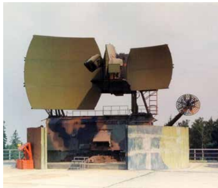
Anténa 5N62V s kabinou K-1B
