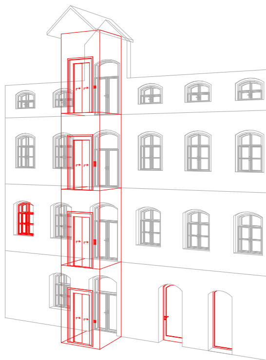
pozice výtahu v místě, kde se dříve tahaly venkem žoky s chmelem
