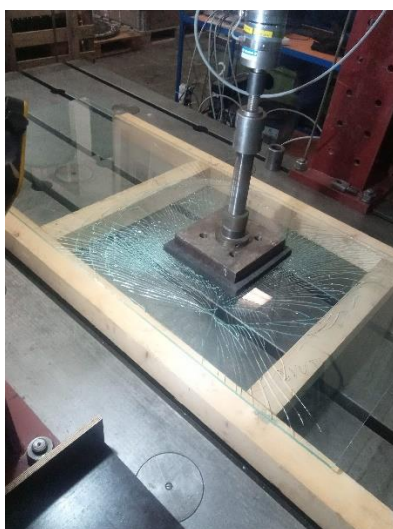
Obr. č. 39, Prasknuté sklo v procese
