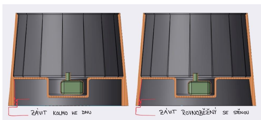
Obr. 31: Varianty uzavírání spodní části (řez), vlastní obrázek autorky
