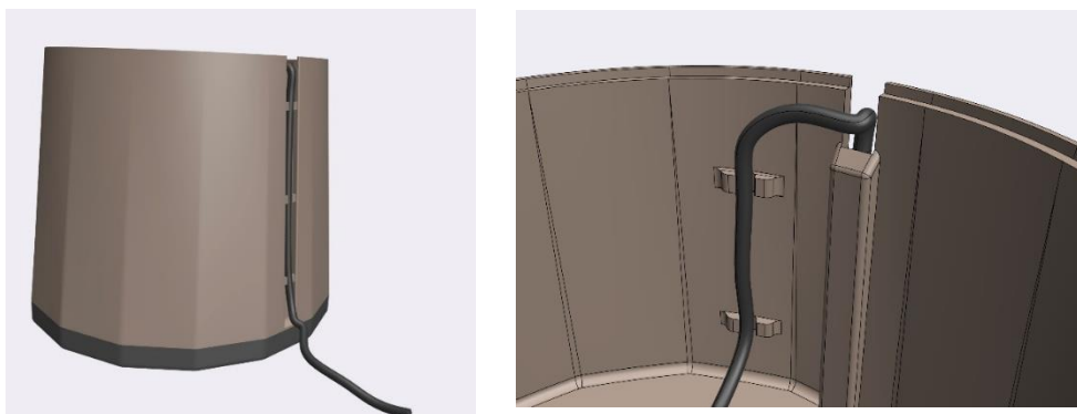
Obr. 37: Vývod a uchycení kabelu, vlastní obrázek autorky
