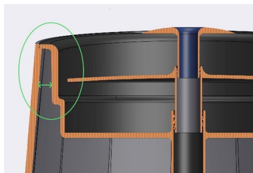
Obr. 35: Tvar vnitřní misky (řez), autor
