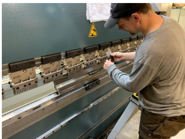
Obr. 34: Ohýbání vylaserovaných pásů podnože
