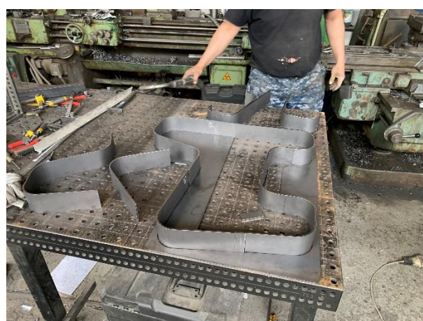
Obr. 35: Svařování naohýbaných pásů podnože
