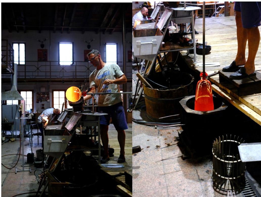
Obr. 117: Proces foukání vnějšího skla
