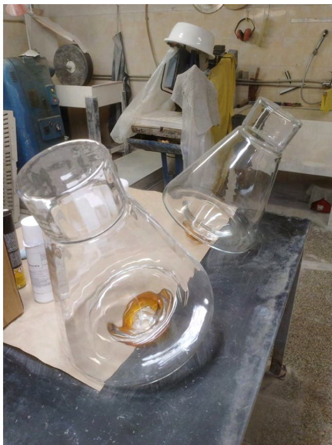
Obr. 123: Sklo před pukáním a broušením
