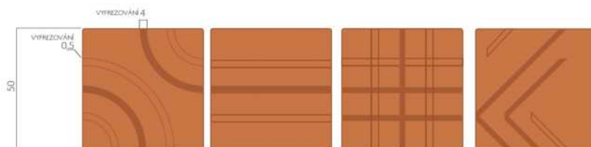
Obr. 57 První návrh destiček Orientace, kombinace dvou velikostí frézování (Zdroj: archiv autorky)
