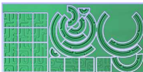
Obr. 65: Grafické znázornění v CNC programu červené 8 mm desky (Zdroj: archiv autorky)
