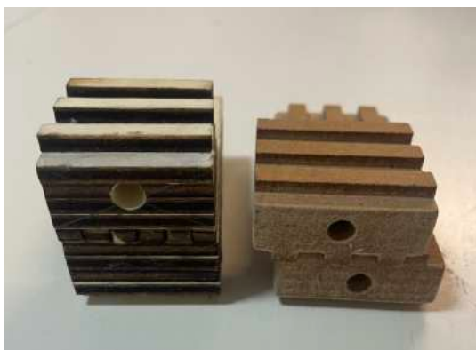
Obr. 72: Správný prototyp z lepené překližky a MDF desky s rozměry zámku 5,5 mm a 6 mm, ukázka se zaměřením na zarovnání (Zdroj: archiv autorky)
