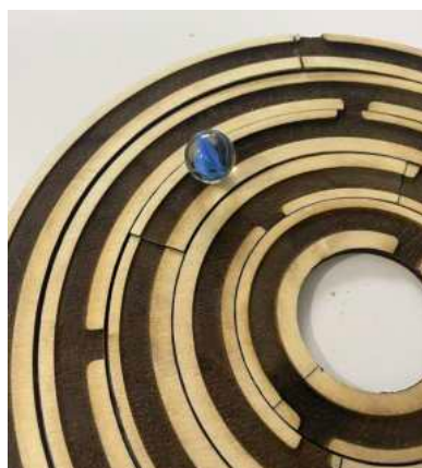
Obr. 40 Vygravírovaná překližka – prototyp hry Balance (zdroj:archiv autorky)
