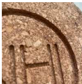
Obr. 45: Zkouška frézování do korku (Zdroj: archiv autorky)
