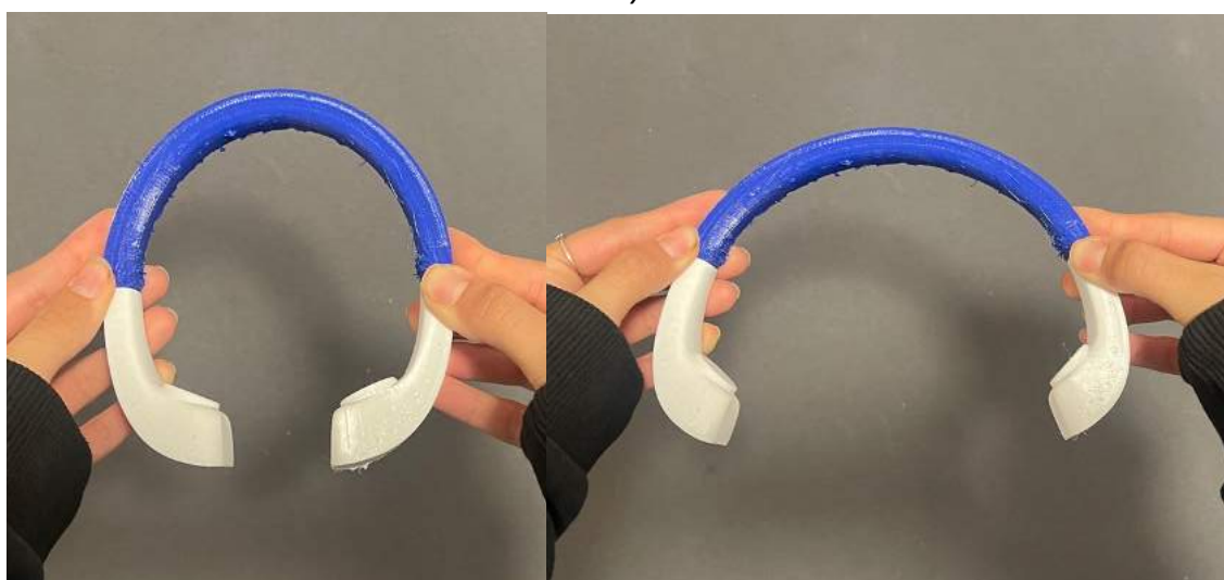
Namáhání elektrolarynxu v celé sestavě
