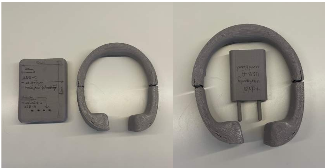
Zkouška velikosti adaptéru s powerbankou oproti elektrolarynxu
