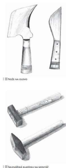
Obr. 6: Nože na olovo a sklenářská kladívka na montáž vitráže (LOSOS, 2011)
