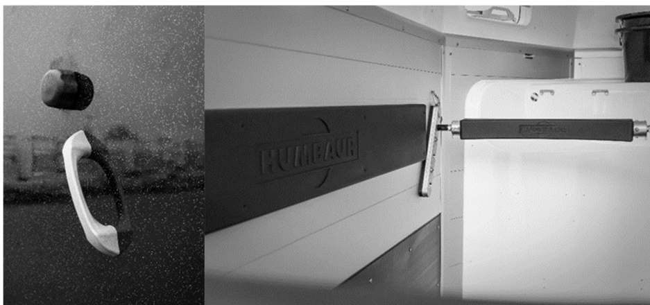
Obr. 69: Detail ovládacího kolečka panik systému z vnější strany
