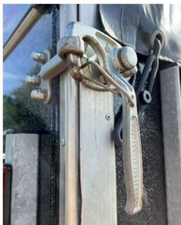
Obr. 77: Klika na zajištění zavřené rampy (archiv autora, září 2023)
