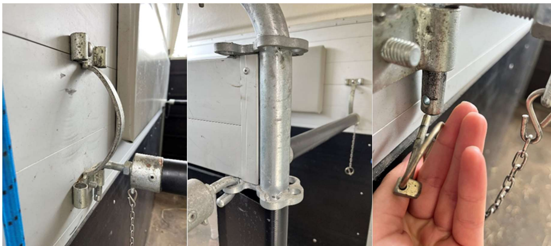
Obr. 95: připevnění boxové tyče k boční stěně přívěsu (archiv autora, říjen 2023)
