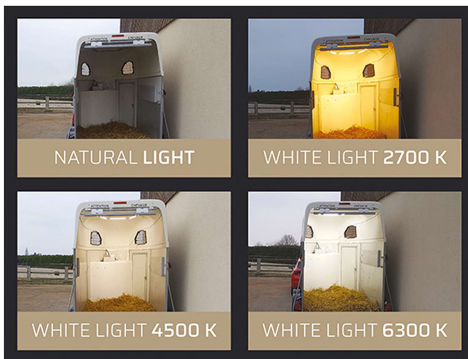
Obr. 73: Nasvícení přívěsu přirozeným světlem a různými barevnými teplotami
