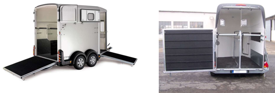
Obr. 75: Sklopení přední a zadní rampy
