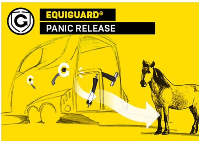
Obr. 67: Skica vysvětlující fungování panik systému od firmy Humbaaur
