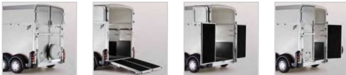
Obr. 74: Otevírání rampy jako dvoukřídlé dveře
