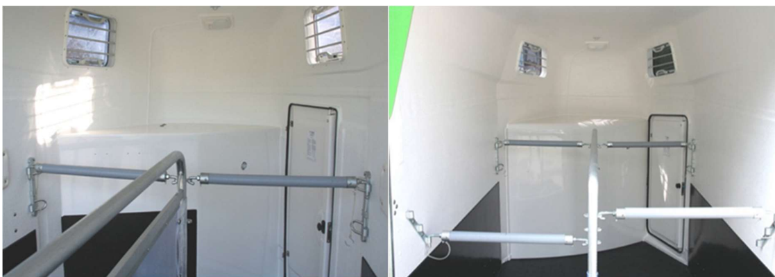
Obr. 93: Prsní tyče v přívěsu Thiel Compact
