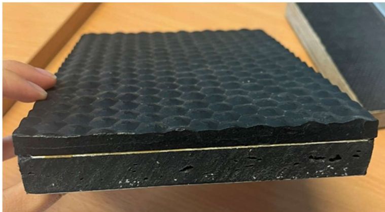
Obr. 101: Vzorek ALUBICOMP podlahy (archiv autora, říjen 2023)
