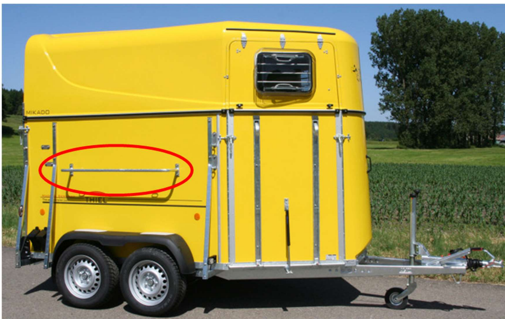
Obr. 81: Přívěs s bočním odkládacím madlem (upraveno)
