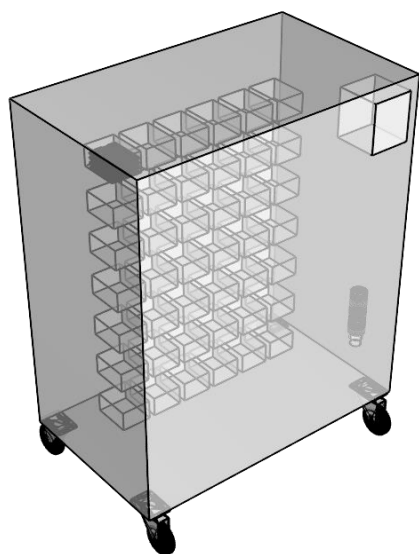
obrázek 33 vnitřní rozvržení zásobníků
