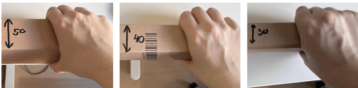
obrázek 60 model madla v měřítku 1:1 – varianty tloušťky
