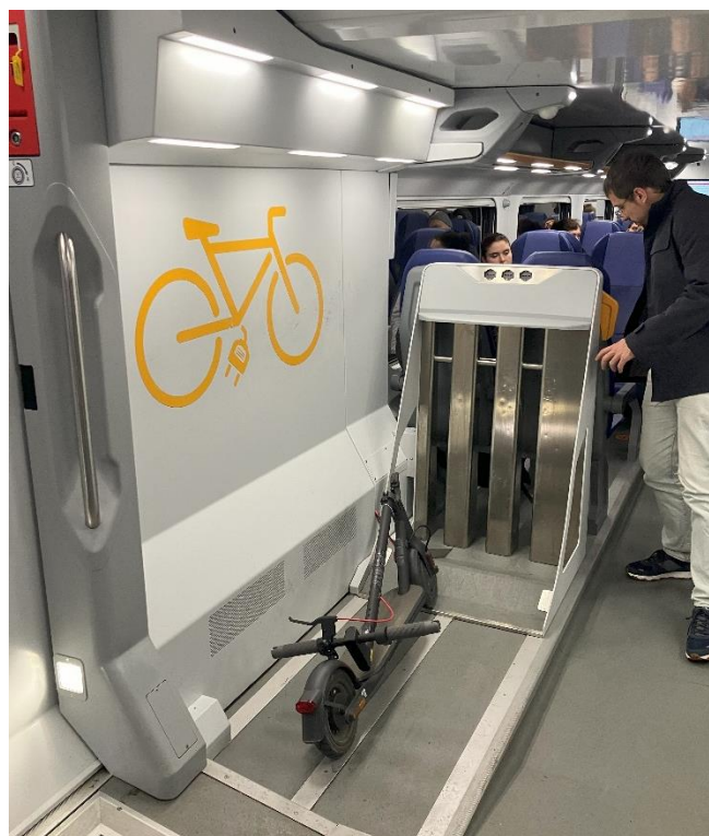
Obr. 2: Stojan na jízdní kola, nebo elektrokola ve vlaku od společnosti Trenitalia
