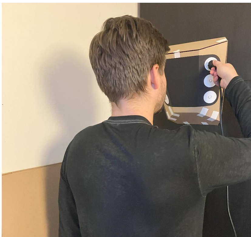
Obr. 59: Testování dostupnosti zásuvek a ergonomické dostupnosti – osoba výšky 175 cm
