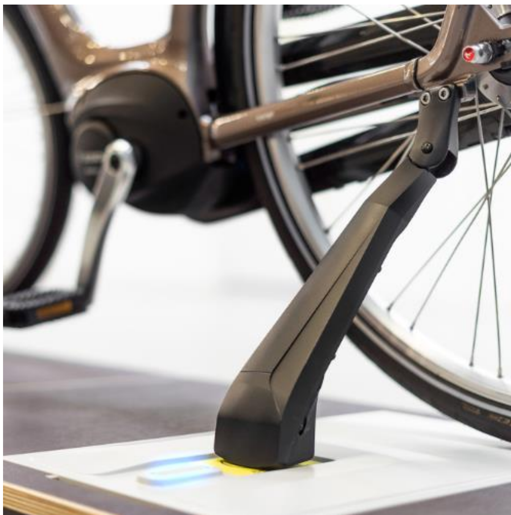
Obr. 11: Indukční dobíjení pomocí dlaždice a stojáčku od firmy Tiler
