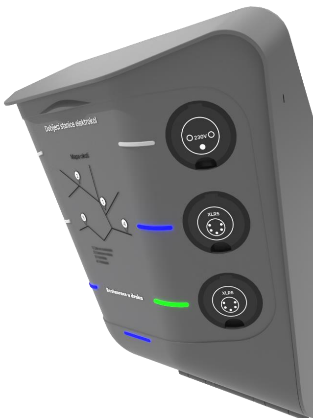
Obr. 72: Světelná signalizace aktivně zapojeného konektoru (modré světlo) a dobitého akumulátoru (zelené světlo)
