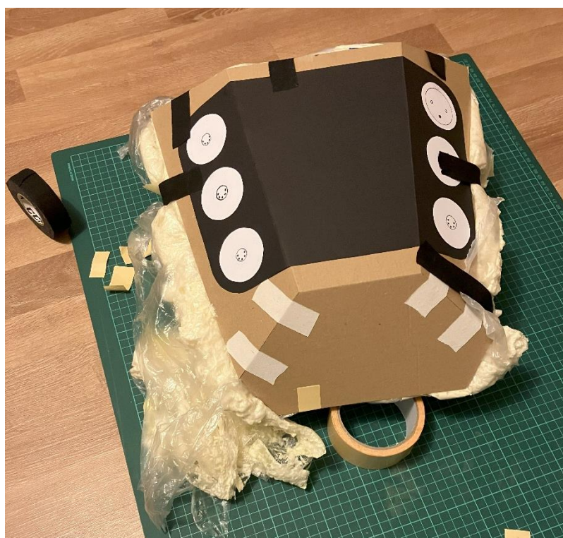
Obr. 62: – Výroba pěnového modelu formováním pěny do kartonového modelu
