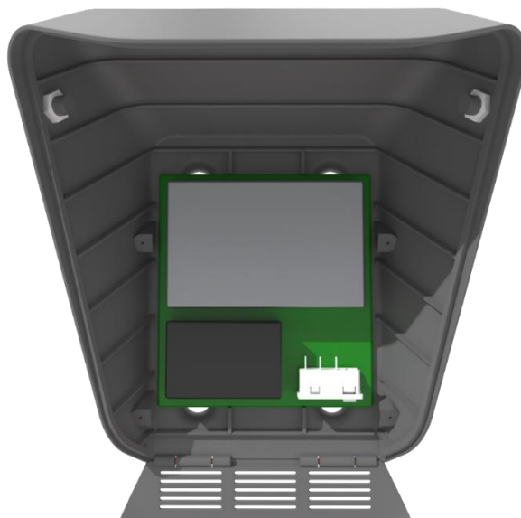
Obr. 79: Za krytem umístěná pájená deska s hlavními komponentami přívodu zdroje, počítače (černá krabička) a transformátoru (světle šedá krabička)
