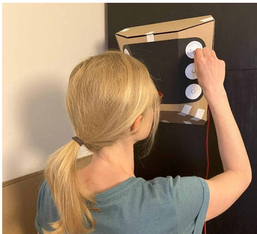
Obr. 61: Testování dostupnosti zásuvek a ergonomické dostupnosti – osoba výšky 160 cm
