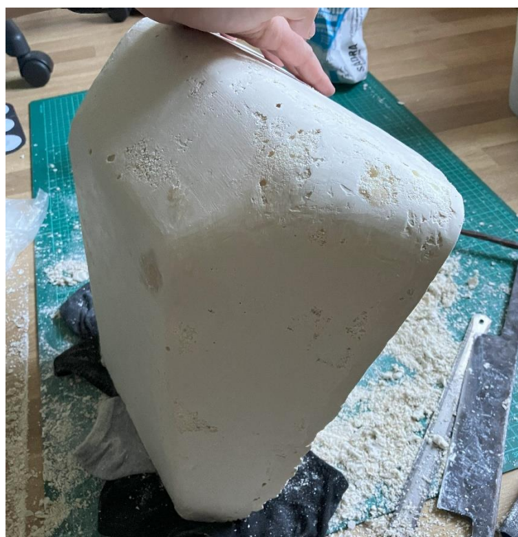
Obr. 64: Zpracování zasádrovaného pěnového modelu pro vyzkoušení detailů
