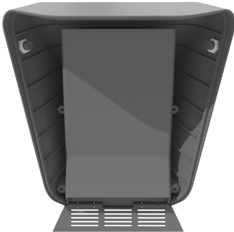
Obr. 78: Kryt elektronické pájené desky, který zároveň slouží jako držák sestav jističů, relé a měničů, a zároveň funguje jako přepážka pro proudění vzduchu větracími mřížkami, aby se chladily součásti, především transformátor stejnosměrného proudu
