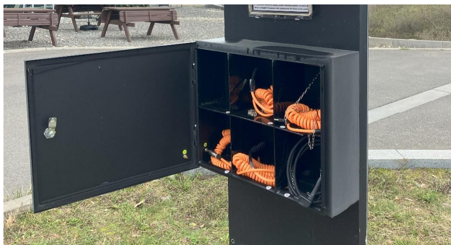
Obr. 20: Box na nástrčné kabely od firmy Powerbox
