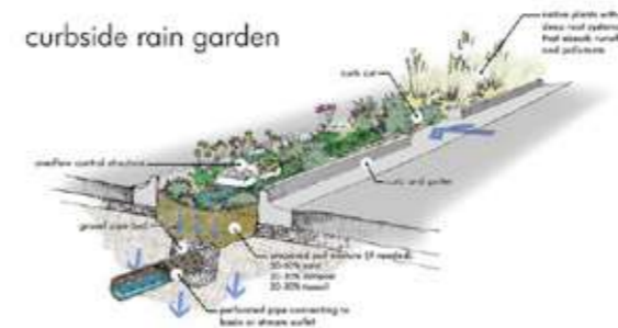
Obr.č. 19 Rozvody vody v záhonech, zdroj https://cz.pinterest.com/pin/467952217513151791/
