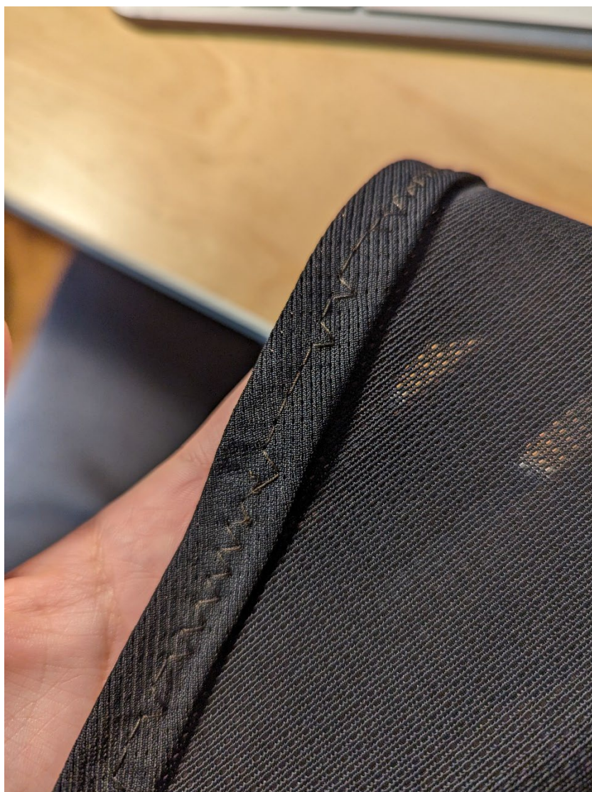
Obrázek 55 - Vynechávající stehy na elastické látce
