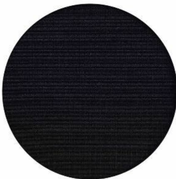
Obrázek 27 - Robic Nylon s ripstop úpravou
