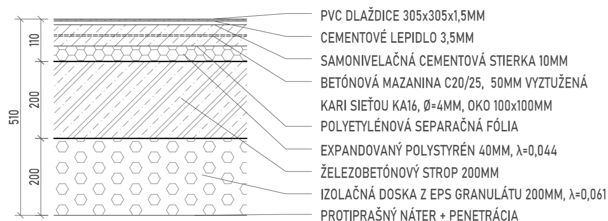
P02 - PARTER HLAVNÝ POVRCH
