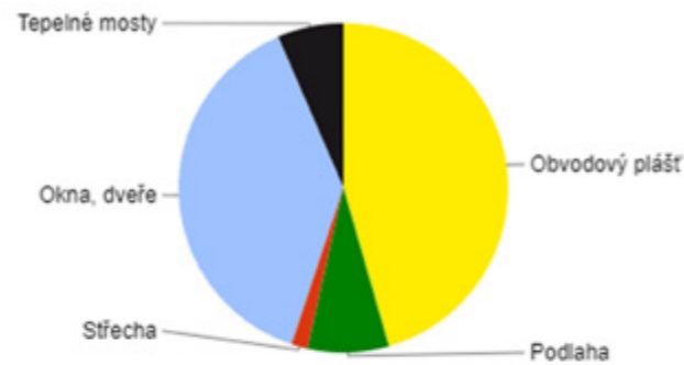
Tepelné ztráty jednotlivými konstrukcemi
