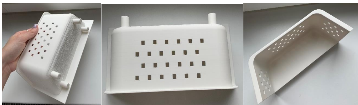
Obr. 113, 114 a 115: Vnitřní část lampy – 3D tisk, foto autor
