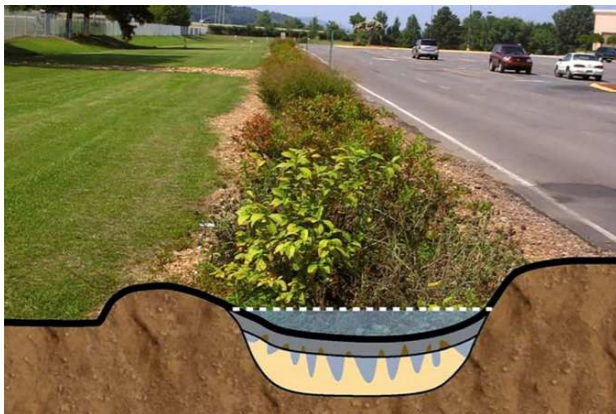
Princip dešťového záhonu
