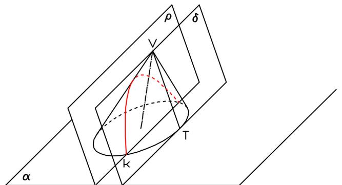
3. Vrcholová rovina  $\delta$  a podstavná kružnice  $k$  mají dva společné body  $P, Q$ . Rovina  $\rho$  je rovnoběžná s přímkami  $PV$  a  $QV$ , tj. průsečíky  $PV$  a  $QV$  s rovinou  $\rho$  jsou nevlastní body. Průnikem kuželové plochy s rovinou  $\rho$  je **HYPERBOLA**.
