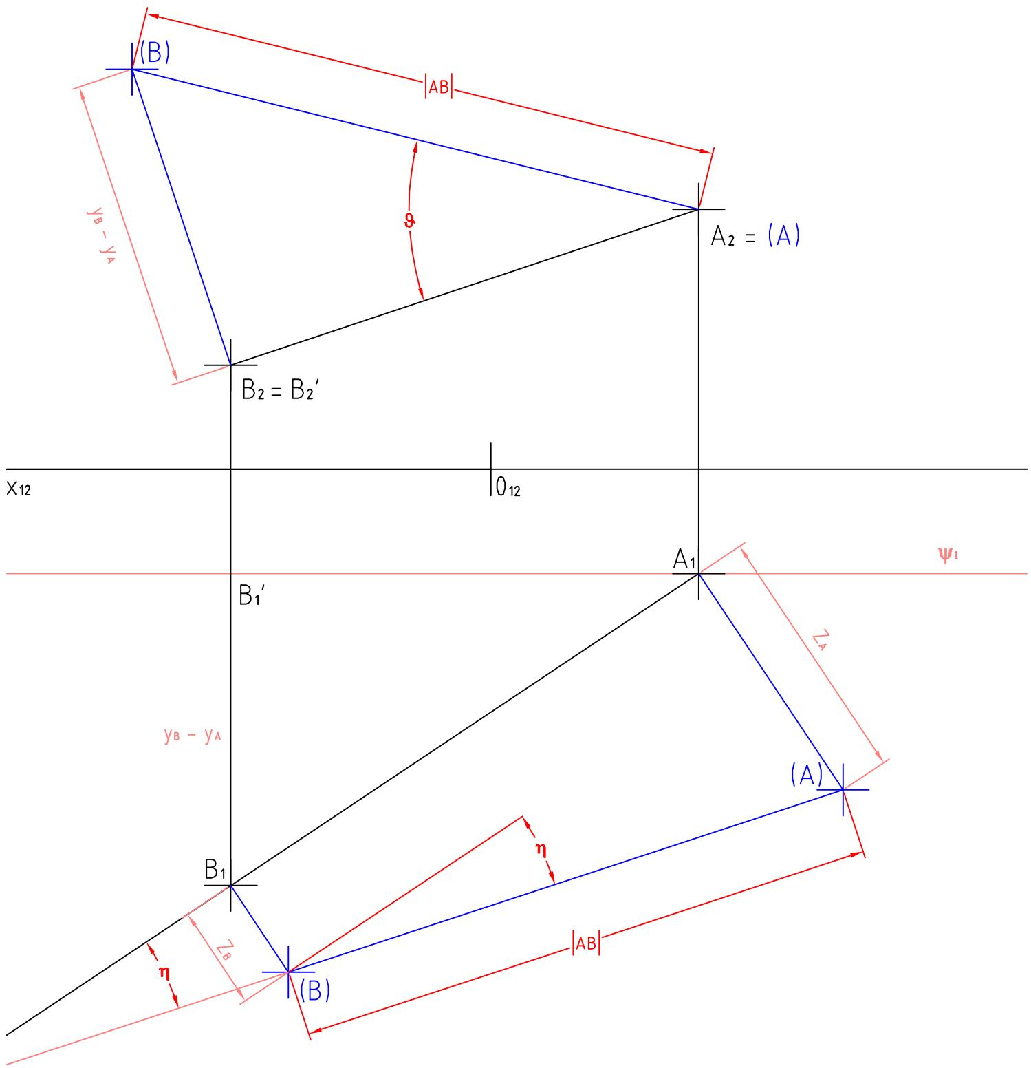
a) Skutečnou velikost úsečky AB zjistíme pomocí lichoběžníku A A<sub>1</sub>B<sub>1</sub>B (tzv. PROMÍTACÍ LICHOBĚŽNÍK). Velikost strany A<sub>1</sub>B<sub>1</sub> máme v půdoryse, lichoběžník sestrojíme přímo k půdorysu úsečky AB. Vlastně sklápíme (otáčíme o 90°) rovinu lichoběžníka do půdorysny. Sklopené body A, B budeme označovat (A), (B). Skutečná velikost úsečky AB je velikost  $|(A)(B)|$ .
